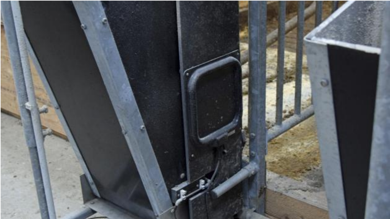
De særlige foderkasser fremstillet af Allflex registrerer hver kalvs indtag af foder. I bunden ses ledningerne til de særlige sniffere, som måler udåndingsluftens indhold af methan. Foto: Peter W. Mogensen.
